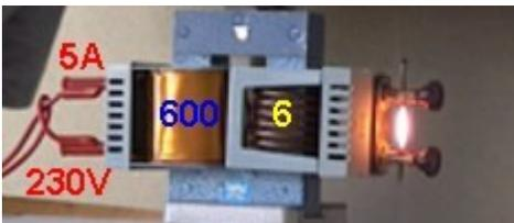
Ein idealer Trafo mit 600 Primärwicklungen und 6 dicken Sekundärwicklungen wird an 230 V Wechselstrom angeschlossen und sekundärseitig durch einen Nagel kurzgeschlossen, der zu glühen beginnt. Der Primärstrom wird mit 5A gemessen. **(2 BE)**
