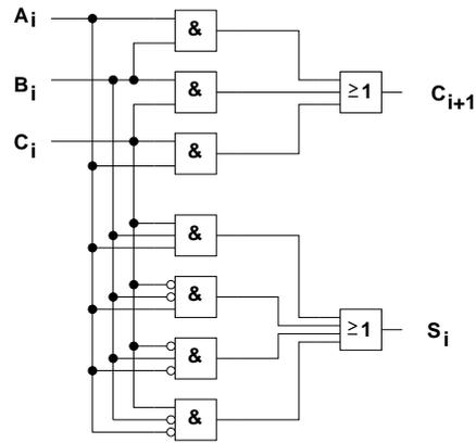
Um zwei  $n$  Bit breite Dualzahlen zu addieren, werden einfach  $n$  Addierer aneinandergereiht. Für die niederwertigste Stelle kann ein Halbaddierer verwendet werden, weil kein eingehender Übertrag berücksichtigt werden muss. Da die Summe von zwei  $n$  Bit Zahlen maximal  $n + 1$  Bit breit ist, stellt der Übertrag der höchstwertigen Stelle das  $n$ -te Summenbit dar.
