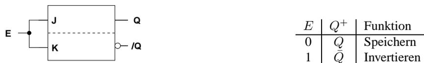
**Taktgesteuerte Flipflops** In vielen Fällen soll ein Flipflop erst zu einem ganz bestimmten Zeitpunkt auf seine Eingangssignale reagieren und in den entsprechenden Zustand übergehen. Dieser Zeitpunkt wird durch das sog. *Taktsignal* (oder kurz: Takt) bestimmt, das in der Regel eine gleichmäßige Rechteckschwingung ist, d.h. ständig zwischen 0 und 1 wechselt.
