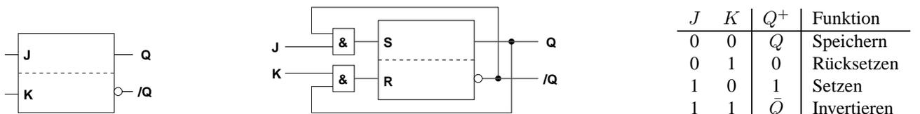
Das *T-Flipflop* (von engl. to toggle = umschalten) ist eine Spezialform des JK-Flipflops, bei dem beide Eingänge gleich angesteuert werden. Das heisst, bei aktiviertem Eingang schaltet das Flipflop ständig um, es schwingt.
