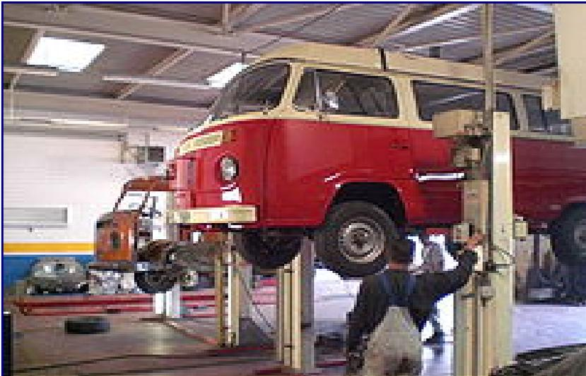
Arten: hydraulisch, mit Spindeltrieben, mit Gelenkketten oder mit pneumatischem Antrieb (Luftbalg)
